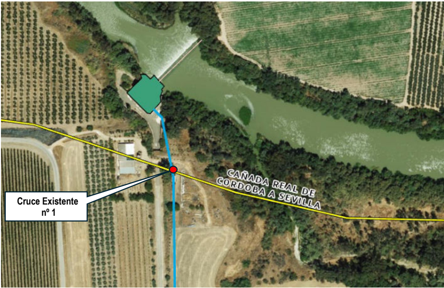
Imagen 3. Cruce existente nº 1 de tubería de impulsión sobre la Cañada real de Cordoba a Sevilla
